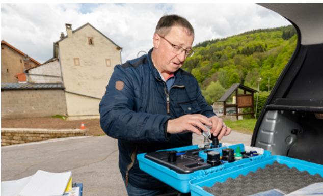
All Woch gi Waasserprouwe vu verschiddene Plazen am Waasserréseu zu Déiljen an um Grondhaff geholl. Gemooss gëtt de Reschtchlorgehalt.
