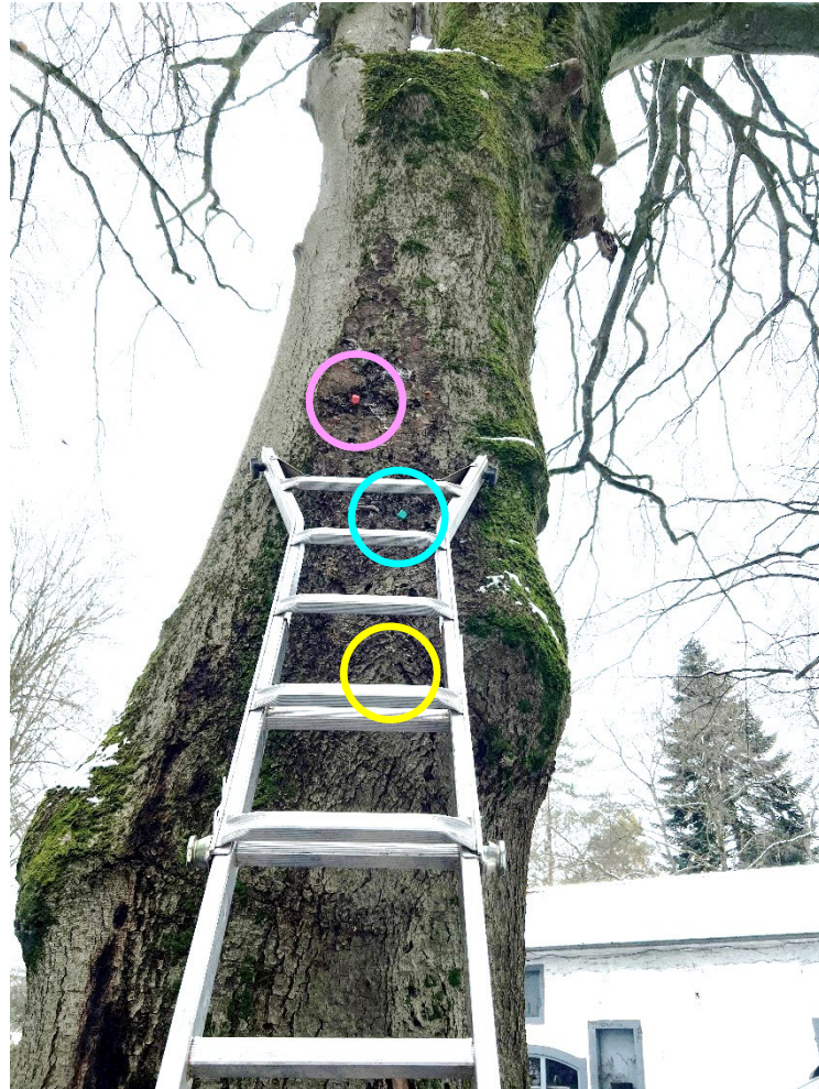
Abbildung 9 zeigt die etwaige Lage der Bohrwiderstandsmessungen 1 (rosa Kreis), 2 (türkiser Kreis) und 3 (gelber Kreis).
